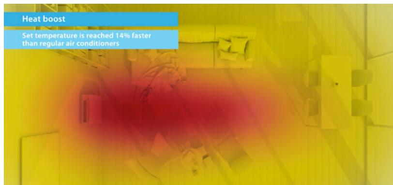
\* En combinaison monosplit uniquement avec les groupes de type RXM-R. Conditions de test de la fonction “Heat Boost” : Démarrage à 2°C temp. ext., 10°C température intérieure, et température de consigne de 23°C. Résultat obtenu pour le modèle 3.5 kW.
